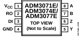
Figure 5. ADM3071E/ADM3074E/ADM3077E Pin Configuration
