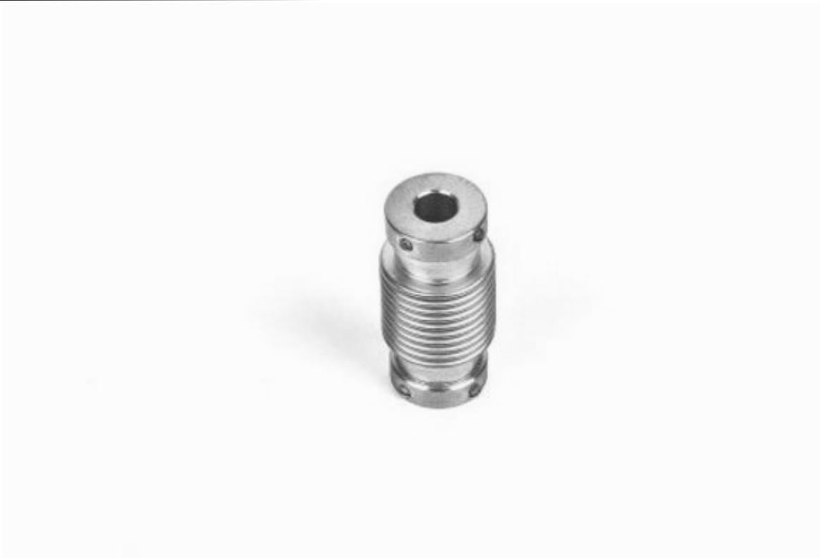
Сильфонная муфта для сопряжения вала малогабаритного энкодера с валом позиционируемого объекта. Упругим элементом является сильфонная трубка.
